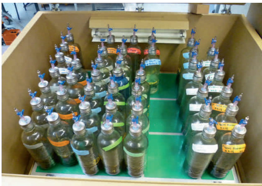
Fig. 1 Standardisierte anaerobe Versuche zur Bestimmung des Methanbildungspotenzials bei der Vergärung verschiedener BAW
